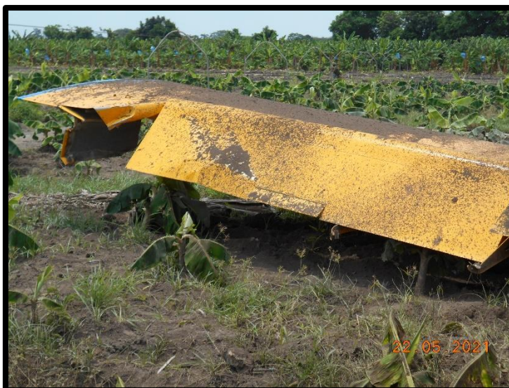
Fotografía No. 5 Vista del daño del ala izquierda.
