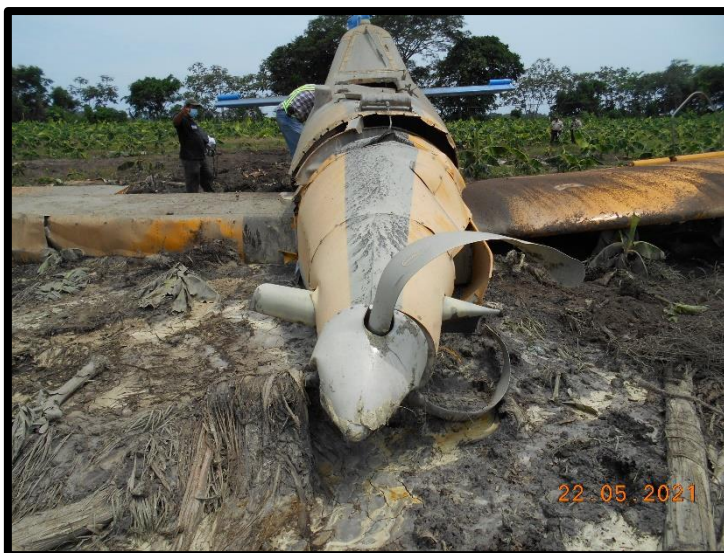
Fotografía No. 4 Vista de los golpes en las aspas de la hélice.
