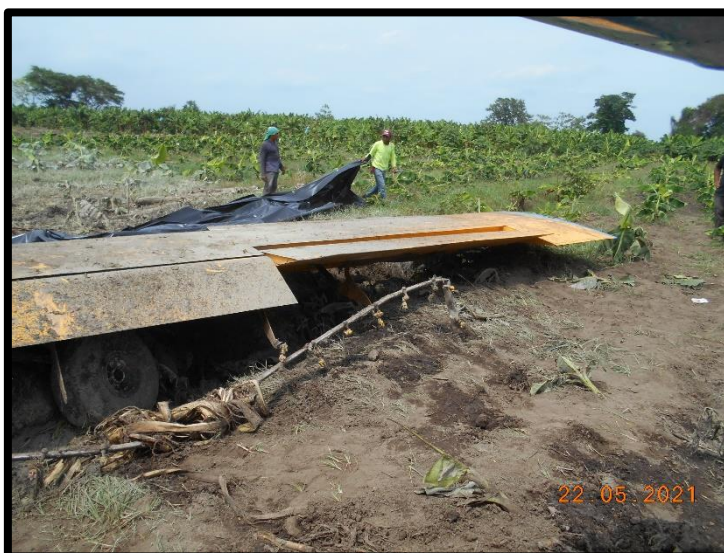
Fotografía No. 6 Vista del flap extendido del ala derecha.
